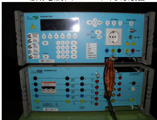
4. ファーストランジェント/ バーストイミュニティ試験装置
