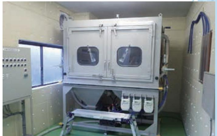
**防塵試験装置 (IP5X・IP6X)**
