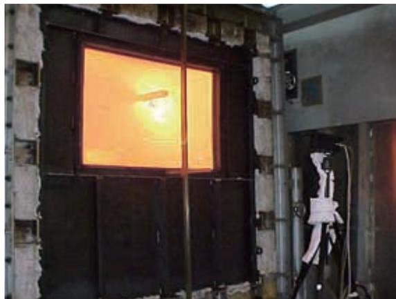
防火窓の標準火災試験(FTPコードPart3)
