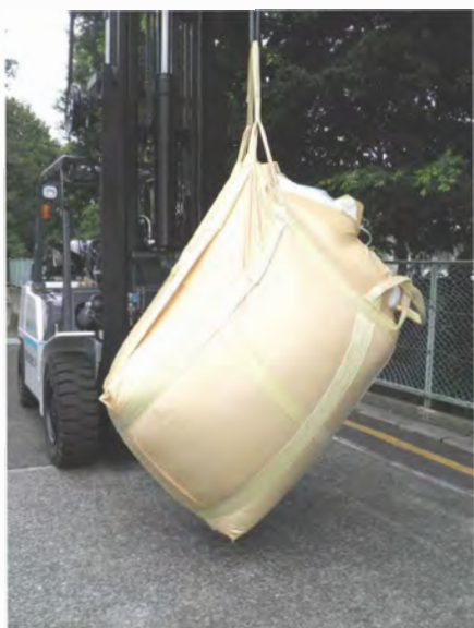
4. 引き起し試験設備
