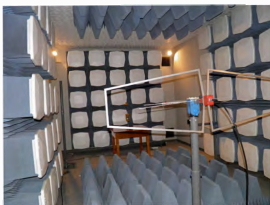
1. 電波暗室（内部）
