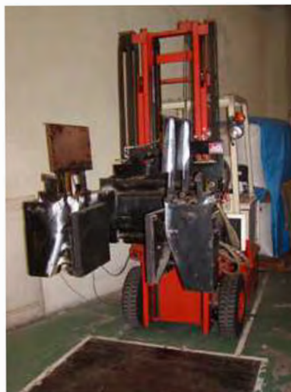
5. 落下試験設備
