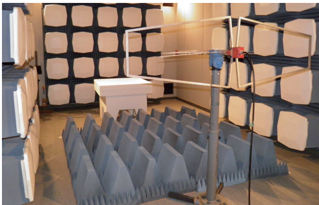
EMC試験（電波暗室）
