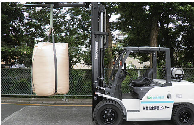
フレキシブルコンテナ (FIBCs) の落下試験
