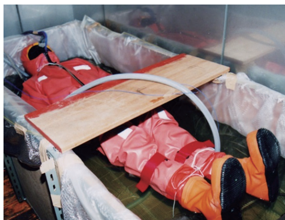
イマーシヨンスーツの保温性能試験(恒温恒湿室)
