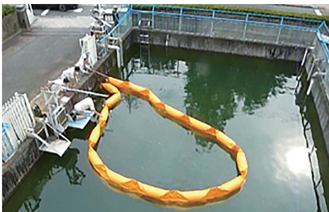
オイルフェンス試験（屋外試験水槽）
