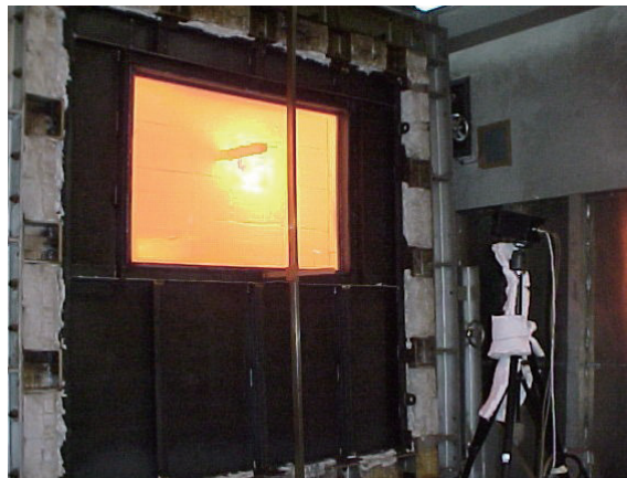
防火窓の標準火災試験(FTPコードPart3) (試験棟:標準火災試験装置)
