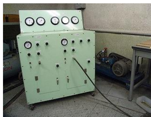
9. 水圧試験装置&水圧ポンプ
