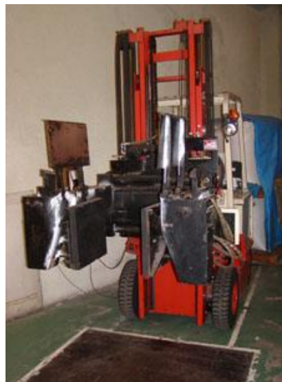
5. 落下試験設備
