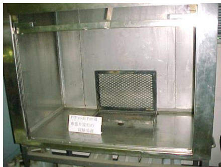
7. 布張家具火災試験機（FTP コード Part8）
