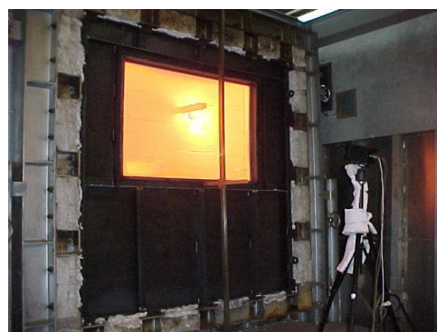
4. 標準火災試験装置 (FTP コード Part3 & 4)
