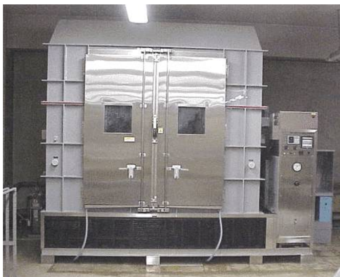
写真 4 大型塩水噴霧試験機 (STP-240S)
