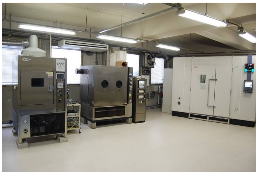
写真5 リニューアルされた耐候性試験室 左からキセノンウェザーメーター、恒温恒湿槽、新恒温恒湿室
