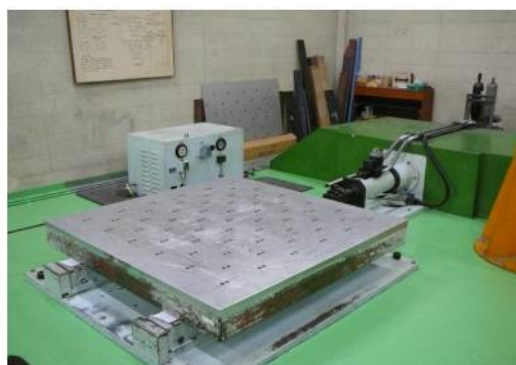
大型電気油圧式振動試験機 (鷺宮製作所 EVH-35) 水平振動台
