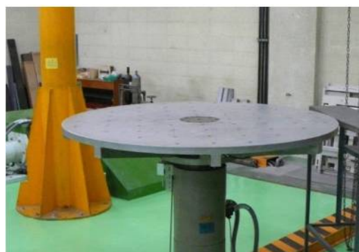
大型電気油圧式振動試験機 (鷺宮製作所 EVH-35) 水平振動台
