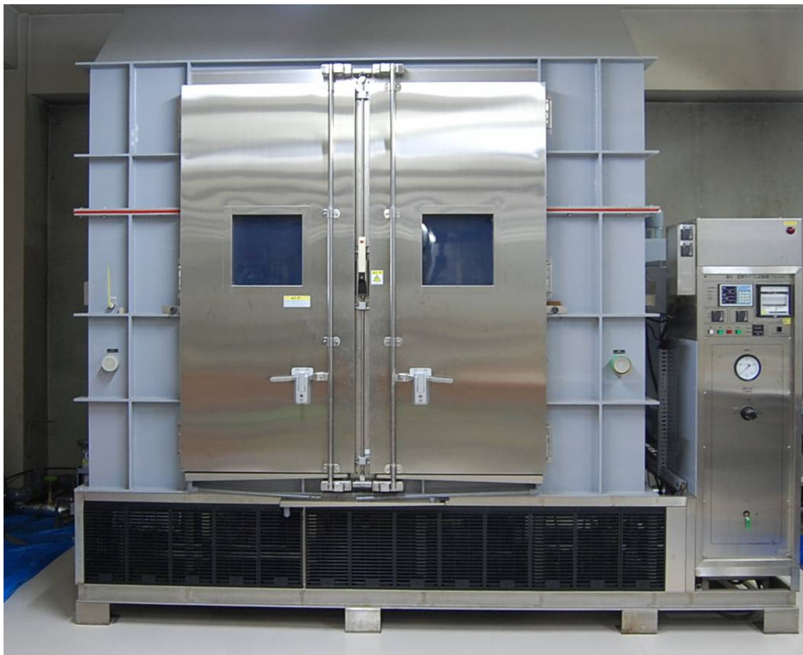
大型塩水噴霧試験機 型式 STP-240S 型
