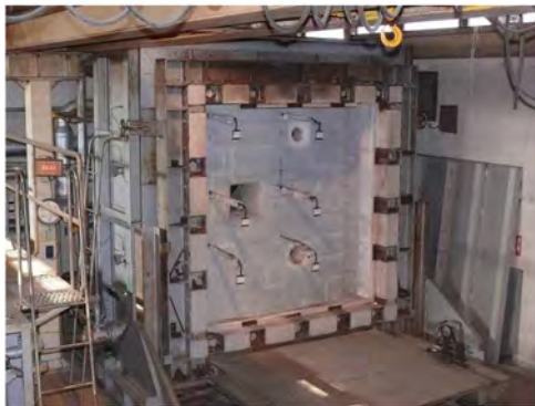
4. 標準火災試験装置 (FTPコード Part3 & 4)
