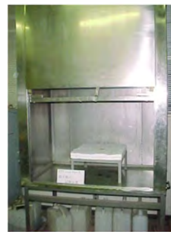
8. 寝具類の着火性試験（FTPコード Part9）
