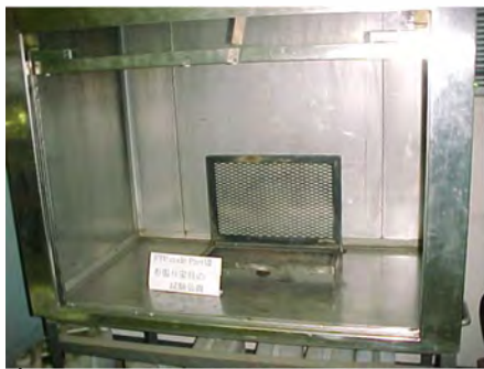
7. 布張家具火災試験機（FTPコード Part8）
