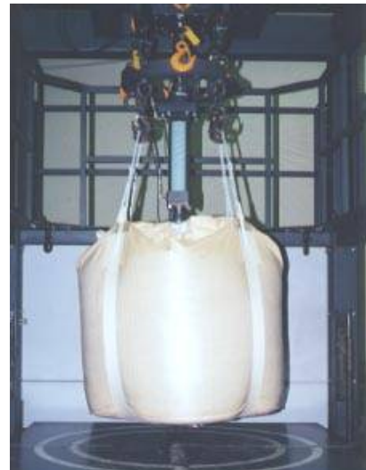
写真4 繰返し頂部つり上げ試験
