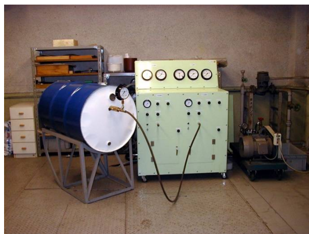
写真3 ドラム缶の水圧試験
