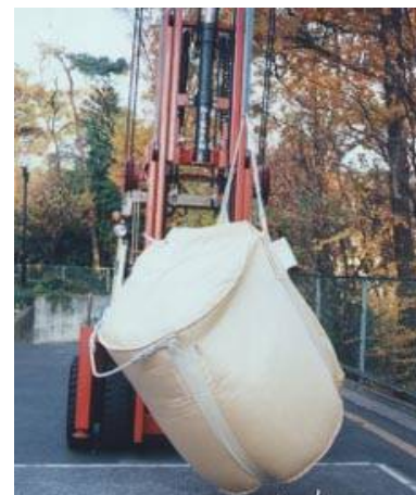
写真5 引き起こし試験
