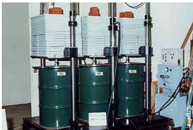
写真2 ドラム缶の積み重ね試験
