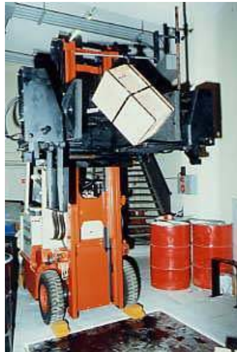
写真1 木箱の対角落下試験
