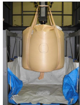
繰り返し頂部つり上げ試験（FIBCs）
