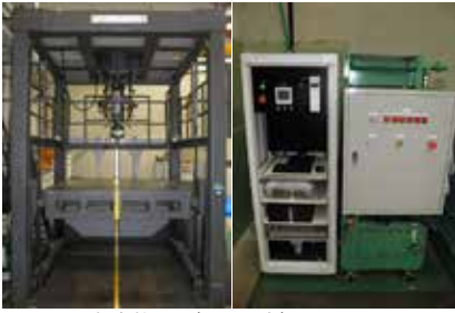
FIBCs 試験装置 (RIME 式) 圧縮型ロードセル 定格容量 200kN 台床 2000×2000mm
