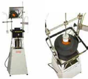
不燃性材料試験機 (FTP/Part1, ISO 1182:2010, ISO 1182:2020) 温度範囲 ~1000℃ 試料寸法 Φ45×H50mm
