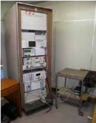
放射電磁界イミュニティ試験装置 (IEC 61000-4-3) 信号発生器 周波数範囲 9kHz~3GHz
