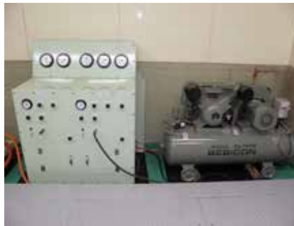
気密試験装置 最高使用圧力 0.93MPa 吐出量 400L/min
