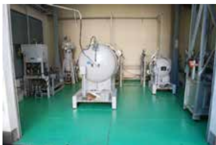
防爆試験装置 内法寸法 Φ600×直線部 500mm Φ1000×直線部 1000mm
