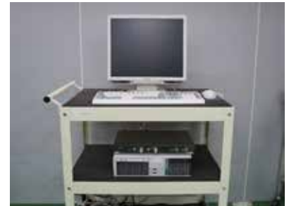
デジタル振動制御装置 ランダム振動 周波数範囲 0.1Hz～20kHz サイン振動 周波数範囲 0.1Hz～20kHz 衝撃波形 ハーフサイン波/のこぎり波/ パーサイン波/台形波 等
