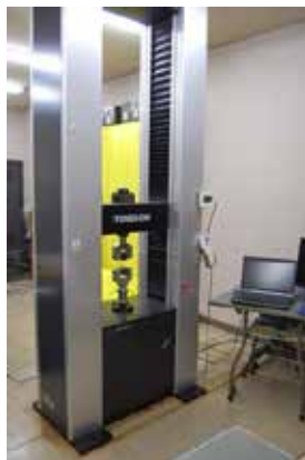
万能引張圧縮試験機 最大荷重 100kN クロスヘッド速度 0.05~1000mm/min クロスヘッドストローク（チャック無）1500mm （材料の引張・圧縮・曲げ試験）
