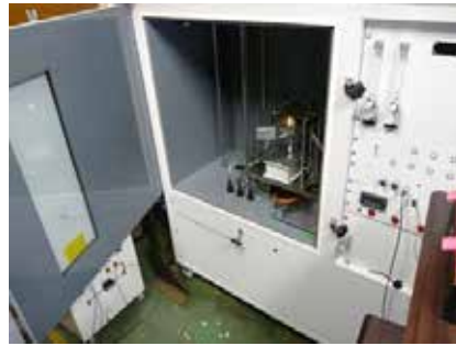
発煙性燃焼ガス有毒性試験機 (FTP/Part2, ISO 5659-2) 試験体寸法 75×75×(最大厚)25mm 加熱条件 10~50kW/m 2
