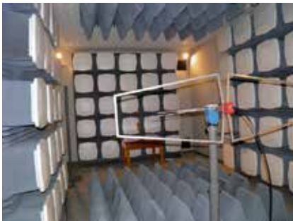
電波暗室 [内部] 内法寸法 W7500mm H3200mm D4000mm 電波吸収体 フェライトタイル、 カーボン含浸ウレタン 電磁遮蔽率 30MHz~2GHz 100dB 以上 サイトアッテネーション ±4dB 以内
