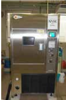
キセノンウェザーメータ （促進耐候暴露試験（紫外線劣化を評価）） ラック寸法 150×70mm 試料回転棒直径 648mm 試料面放射照度 42～80W/m 2
