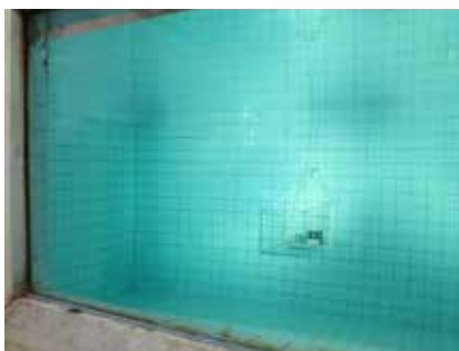
浸水試験水槽〔IPX7〕 内法寸法 W4000mm D2500mm 水深 2000mm
