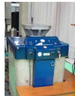
衝撃試験機（ニューマチック方式） 衝撃波形 半正弦波 衝撃加速度 147～19600m/s 2 衝撃持続時間 0.6～20ms 最大搭載質量 90kg 衝撃台 400×400mm
