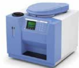
ボンブ熱量計 (SOLAS II -2 発熱量測定) 最大測定範囲 ~40000J 分析時間 約17分(isoperibol法) 準拠規格 ISO 1716、ISO 1928、 DIN 51900等
