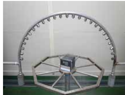
散水試験装置〔IPX3、IPX4〕 直径 800mm/400mm 振動角度±60/±180度 散水ノズル 孔径/孔数 Φ0.5/121
