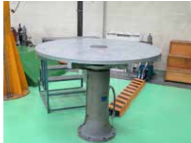
大型電気油圧式振動試験機（垂直加振器） 加振力 30kN 振動数範囲 0～100Hz 最大変位振幅±50mm 最大速度 35cm/s 最大加速度 49m/s 2 （無負荷） 最大搭載質量 700kg 振動台寸法Φ1600mm
