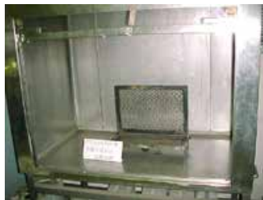
布張家具火災試験機 (FTP/Part8) 試験体寸法 450×450×300mm
