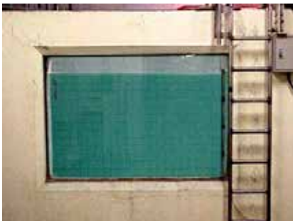
試験水槽 (本館地下) 内法寸法 W4000mm D2500mm 水深 2000mm (各種救命器具の浮力試験、救命胴衣の 浮遊姿勢試験、IPX7(浸水)試験等)
