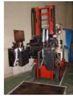
落下試験設備 (RIME 式) 最大落下高さ 2.3m (落下姿勢制御可能) 落下面 鋼板 (W1500×D1500×厚 45mm)
