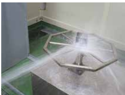
注水試験装置〔IPX5、IPX6〕 ノズル径 Φ6.3mm 及びΦ12.5mm
