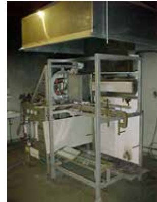
火災伝播性試験機 (FTP/Part5) 試験体寸法 800×155mm 試験体数 3
