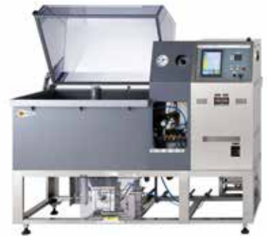
塩水噴霧試験機（JIS、IEC 規格に準拠） 内法寸法 W900mm H500mm D600mm 噴霧溶液 5%中性塩水 35.5℃ 塩水噴霧/乾燥/湿潤サイクル運転可能
