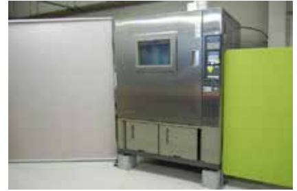
恒温恒湿槽（温湿度サイクル試験） 内法寸法 W1000mm H1000mm D800mm 温度範囲 -40～+100℃ 湿度範囲 20～98%RH
