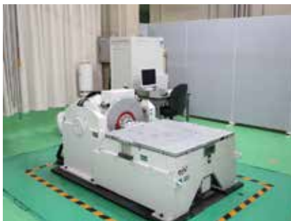
動電式振動試験機 加振力 10kN 振動数範囲 2～2000Hz 最大変位 50mm p-p 最大速度 80cm/s 最大加速度 646m/s 2 （無負荷） 最大搭載質量 300kg 振動台 1000×1000mm
