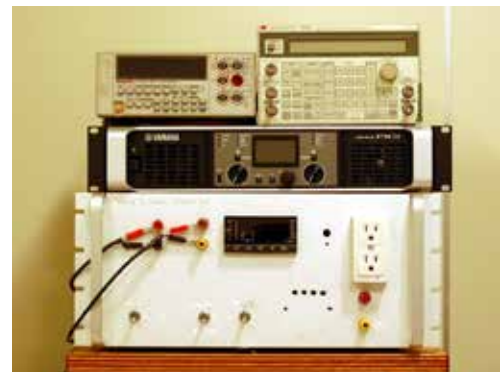
伝導低周波イミュニティ試験装置 信号発生器 周波数範囲 DC~20MHz 音響パワーアンプ 周波数特性 20Hz~20kHz 出力 300W
