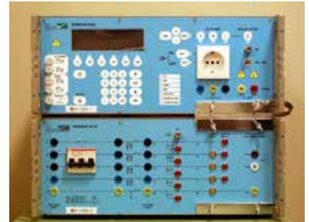
静電気イミュニティ試験装置 (IEC 61000-4-2) 出力電圧 8kV パルスイミュニティ試験装置 (IEC 61000-4-4) 出力電圧 4kV パルス周波数 2.5~100kHz 雷サージ試験機 (IEC 61000-4-5)
