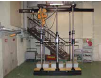
積み重ね試験装置 (容器 3 個同時試験可能) 床台寸法 W2100×D1400mm 積み重ね高さ相当の等価荷重方式
