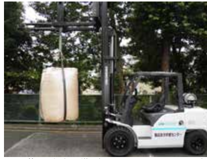
大型落下試験設備 [5ton フォークリフト] 最大荷重 5ton 最大揚高 5500mm 油圧式落下切離し具 使用荷重 3ton
