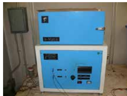
熱伝導率計 0.013~0.37kcal/m・h・°C 試料寸法 300×300mm 厚さ 10~100mm （断熱材・保温材・ガラス・木製品・ プラスチック材等の熱伝導率の測定）
