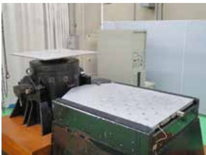
動電式振動試験機 加振力 10kN 振動数範囲 2～3000Hz 最大変位 30mm p-p 最大速度 170cm/s 最大加速度 696m/s 2 （無負荷） 最大搭載質量 150kg 振動台 800×800mm
