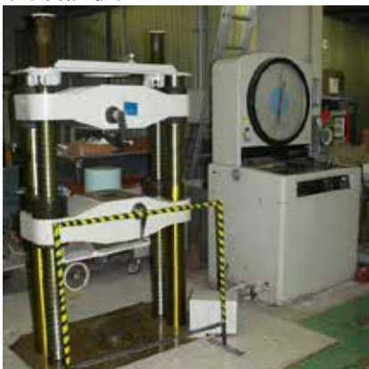
万能材料試験機 最大荷重 1000kN クロスヘッド速度 435mm/min 引張・圧縮最大スパン 1000mm 最大曲げスパン 800mm
