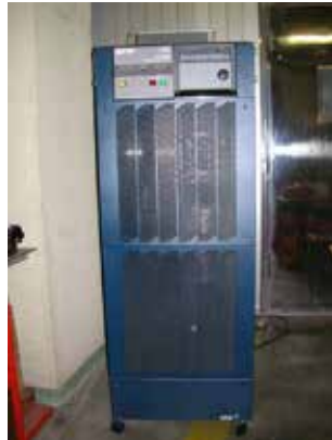
電源変動試験機 出力電圧 0~150V 20A/0~300V 10A 単相・三相 DC 出力周波数 5~1100Hz
