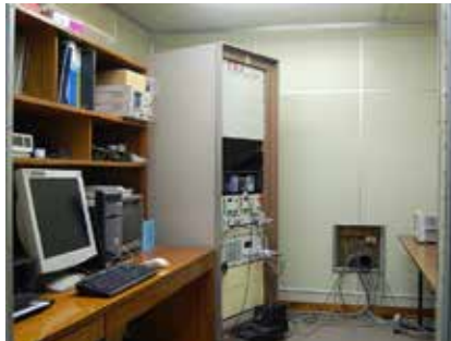
電波暗室 [計測室] 周波数範囲 30MHz~2GHz EUT 電源 直流 0~300V 10A 交流 1Φ50~110Hz 0~300V 10A 3Φ50~110Hz 0~240V 10A
