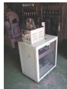
本質安全火花点火試験装置 ガスチャンバ容積 約300ml 電極回転数 タングステン 80rpm カドミウム 19.2rpm
