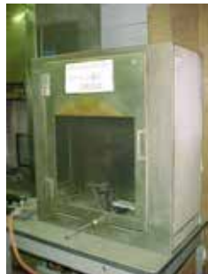
カーテン類耐炎性試験機 (FTP/Part7) 試験体寸法 長さ 170×幅 220mm
