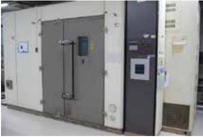
恒温恒湿室（温湿度サイクル試験） 内法寸法 W3020mm H2100mm D1970mm 温度範囲 -40～+80℃ 湿度範囲 20～95%（温度+20～+80℃）
