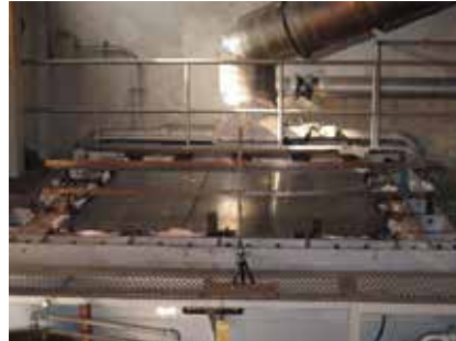
標準火災試験装置〔水平炉〕(FTP/Part3&4) 加熱面積 水平炉 W2500mm D3100mm 試験体寸法 2010 FTP Code, Annex1, Part3 炉内温度 RT~+1100℃ パーナー数6基 炉内温度制御方式 微分積分比例制御方式
