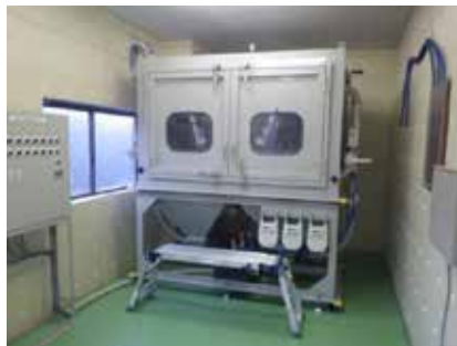
粉じん試験装置〔IP5X、IP6X〕 槽内寸法 W2000mm H1000mm D1000mm 試験品最大重量 100kg 使用粉体 タルク
