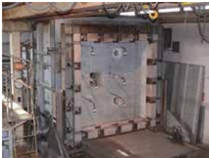
標準火災試験装置〔垂直炉〕(FTP/Part3&4) 加熱面積 垂直炉 W2500mm H2500mm 試験体寸法 2010 FTP Code, Annex1, Part3 炉内温度 RT~+1100℃ パーナー数6基 炉内温度制御方式 微分積分比例制御方式
