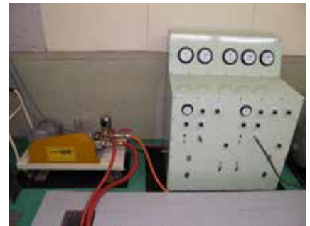
水圧試験装置 最高使用圧力 4.0MPa 吐出量 40L/min
