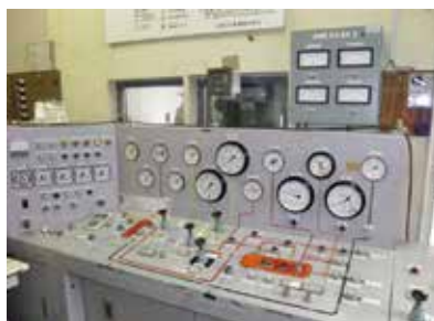
防爆試験装置（制御装置） 試験ガス アセチレン、水素、エチレン、 プロパン、メタン
