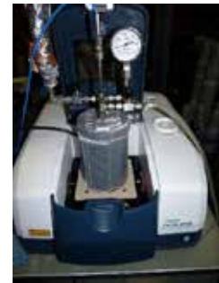
燃焼ガス分析用 FTIR (FTP/Part2) 検出器 MCT, DLTGS 分解 0.5、1.0、2.0、4.0、8.0、16.0cm -1
