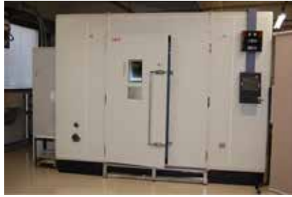
恒温恒湿室（温湿度サイクル試験） 内法寸法 W3020mm H2100mm D2470mm 温度範囲 -40～+80℃ 湿度範囲 20～90%（温度+40～+80℃）
