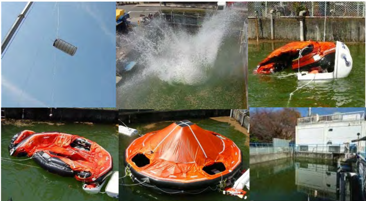
2. 落下試験水槽（膨張式救命いかだの落下試験）
