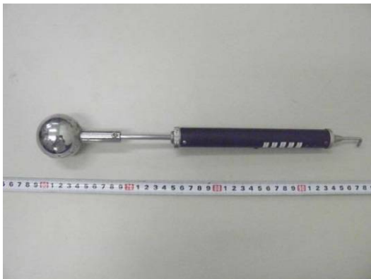
近接度プローブ 直径 50mm IP1X
