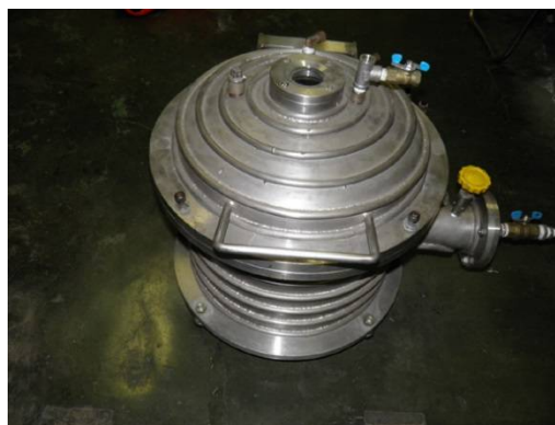
水圧試験機 IPX8 (最大使用水圧:0.3MPa)
