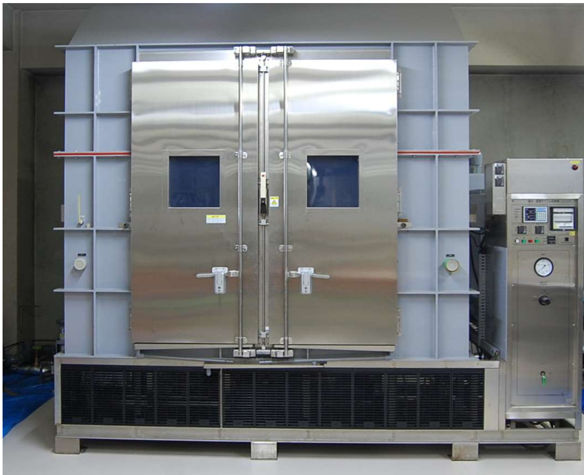
大型塩水噴霧試験機 型式 STP-240S 型
