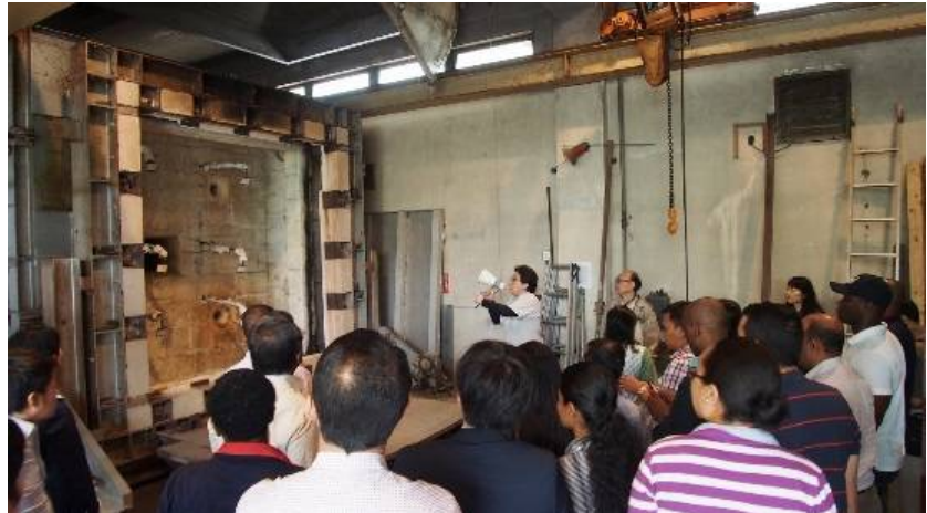
図 2 標準火災試験炉(垂直炉) (昨年 5 月 WMU 世界海事大学の奨学生が見学)
